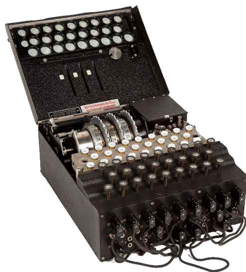
Abbildung 4.1: Eine Enigma. Von vorne nach hinten: Steckerbrett, Tastatureingabe, Lampenfeld, Walzen
